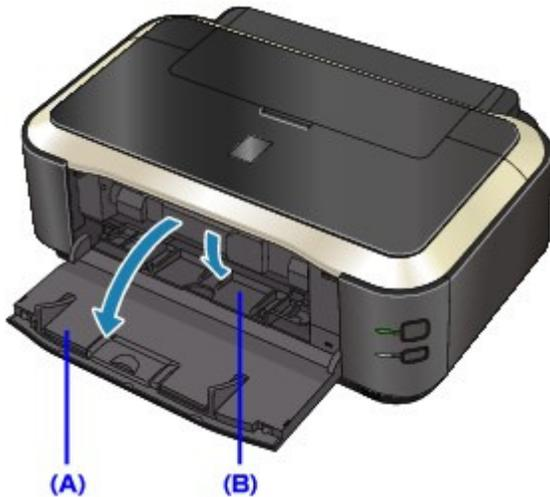
3. Insérez le disque imprimable dans le bac disque.
