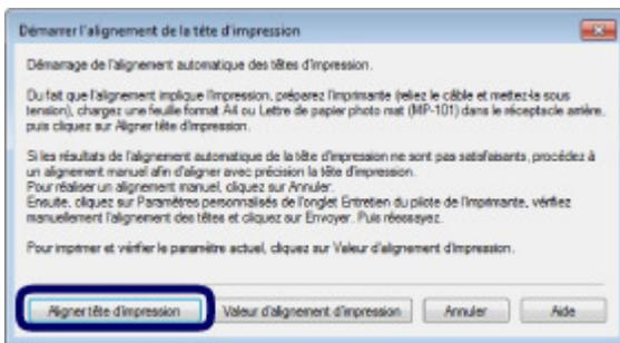
Le motif d'alignement de la tête d'impression est imprimé et la machine ajuste automatiquement la position de la tête d'impression.
