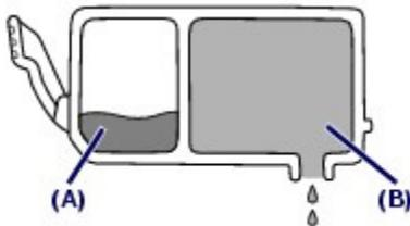
Lorsqu'il n'y a plus d'encre dans la zone (A), le voyant d'encre clignote lentement afin de vous avertir du faible niveau d'encre. Lorsqu'il n'y a plus d'encre dans la zone (B), le voyant d'encre clignote rapidement afin de vous informer que le réservoir d'encre doit être remplacé.
