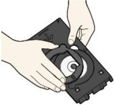
2. Retirez le disque imprimable 8 cm/3,15 pouces du bac disque.
