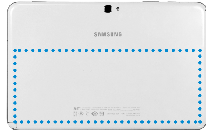
Emplacement de la batterie interne
