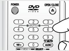
Le bouton **Shuttle <<** permet de ralentir progressivement la cassette, puis de passer en mode Lent, en mode Image figée, en Recherche image inversée et en Recherche Jet inversée.
