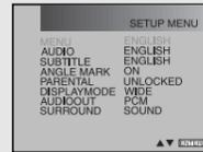
**2** Utilisez les boutons "UP" ou "DOWN" pour sélectionner "ANGLE MARK". Vérifiez que l'angle visuel est activé (sur "ON").
