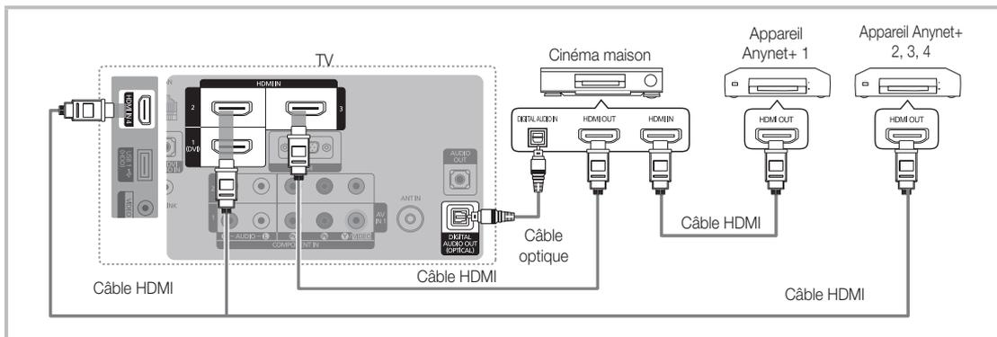
1. Raccordez la prise HDMI IN (1 (DVI), 2, 3 ou 4) du téléviseur à la prise de sortie HDMI OUT de l'appareil Anynet+ correspondant à l'aide du câble HDMI.
