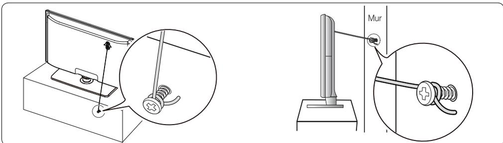
4. Assurez-vous que tous les points d'ancrage sont solides. Vérifiez périodiquement les points d'ancrage afin de détecter tout signe de fatigue ou de bris. En cas de doute au sujet des points d'ancrage, communiquez avec un installateur professionnel.
