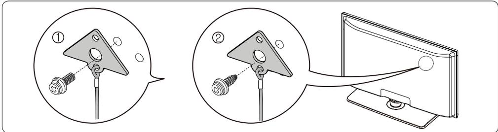
2. Vissez fermement la vis que vous avez fournie (taille M4xL20 ou similaire) à l'armoire ou au mur sur lequel le téléviseur doit être installé.
