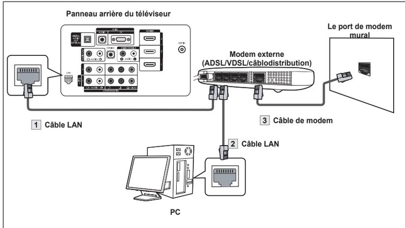
1. Brancher le port [LAN] au panneau arrière du téléviseur au téléviseur au modem externe à l'aide d'un câble LAN.
