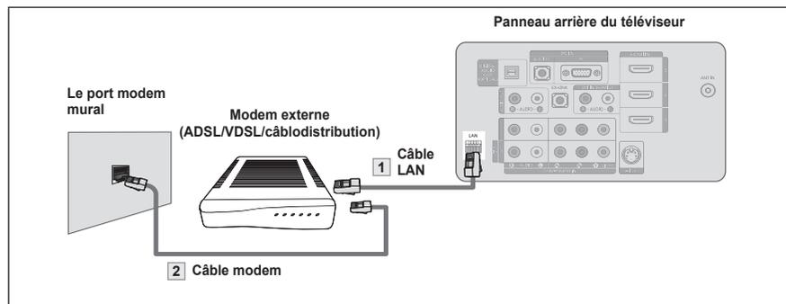
1. Connecter le port [LAN] au panneau arrière du téléviseur et le modem externe à l'aide d'un câble LAN.
