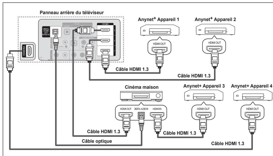
1. Raccorder la prise [HDMI 1], [HDMI 2], [HDMI 3] ou [HDMI 4] du téléviseur à la prise de sortie HDMI OUT de l'appareil Anynet+ correspondant à l'aide du câble HDMI.
