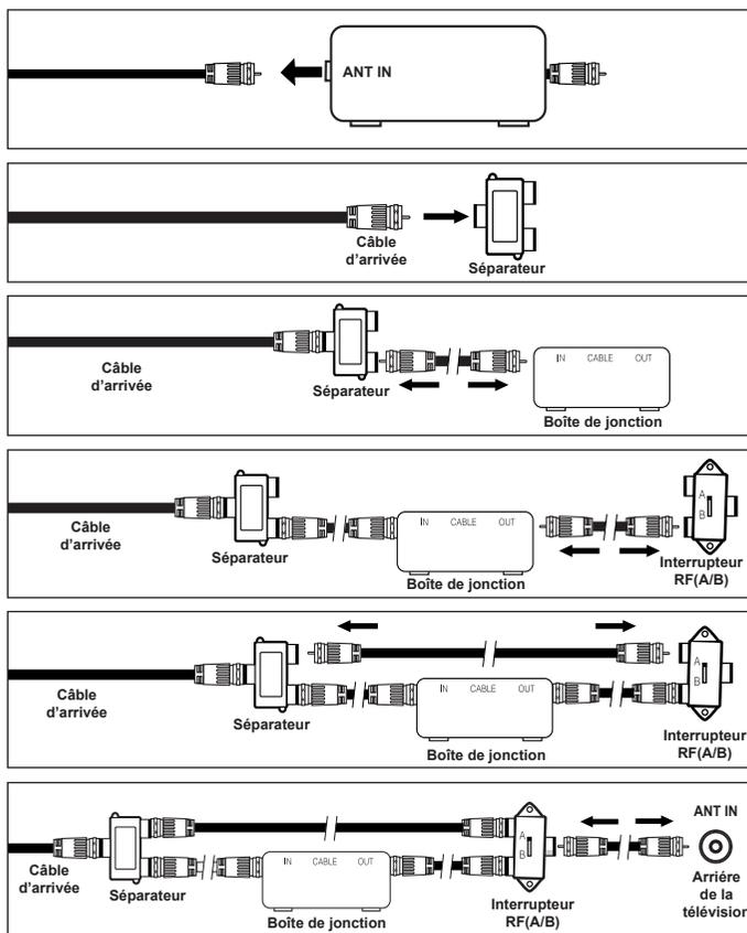
6. Connectez le dernier Câble RF entre la borne OUT du commutateur RF (A/B) et la borne ANT IN située à l'arrière du téléviseur.
