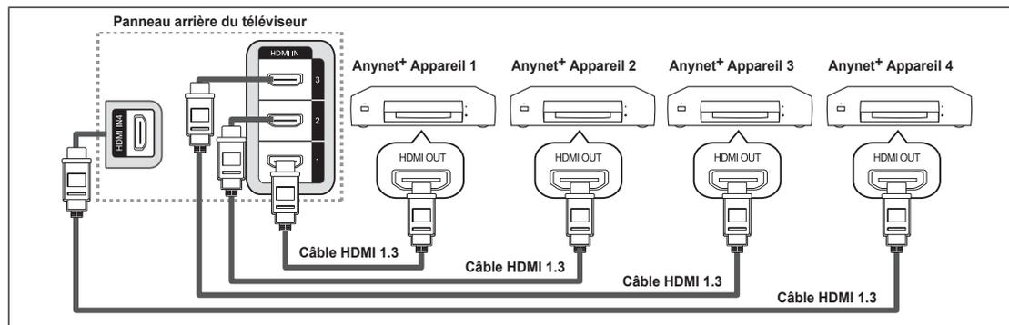
Raccorder la prise [HDMI 1], [HDMI 2], [HDMI 3] ou [HDMI 4] du téléviseur à la prise de sortie HDMI OUT de l'appareil Anynet+ correspondant à l'aide du câble HDMI.
