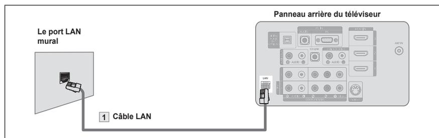
1. Connecter le port [LAN] au panneau arrière du téléviseur et le port LAN mural à l'aide du câble LAN.
