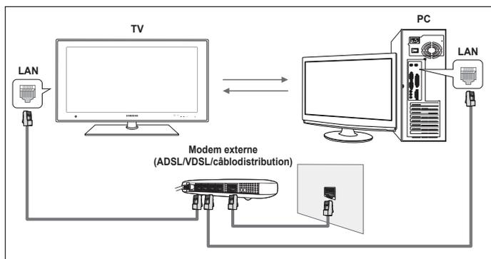
➤ Si le programme de gestion de partage sur PC fourni avec le téléviseur est installé sur l'ordinateur, ce dernier peut assumer les fonctions d'un serveur DLNA par l'intermédiaire du réseau.
