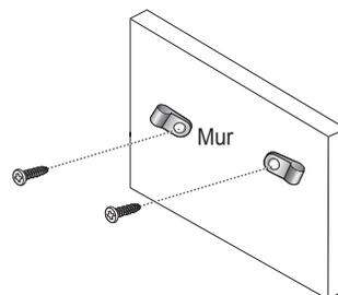
2. Retirer les vis à l'arrière du téléviseur, au centre, passer les vis dans les pièces de retenue, puis reposer les vis sur le téléviseur.
