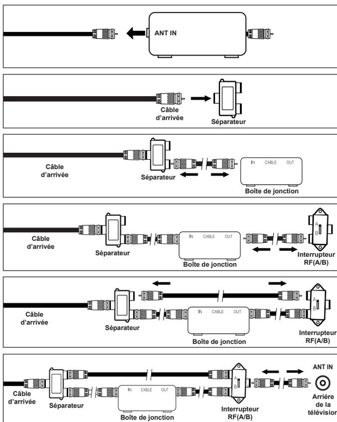
Après avoir établi cette connexion, réglez l'interrupteur A/B en position "A" pour regarder les canal normales. Placez l'interrupteur A/B en position "B" pour une regarder les canal cryptées. (Lorsque vous placez l'interrupteur A/B sur "B", vous devez syntoniser votre télévision sur la canal de sortie de la boîte de jonction qui est habituellement la canal 3 ou 4.)
