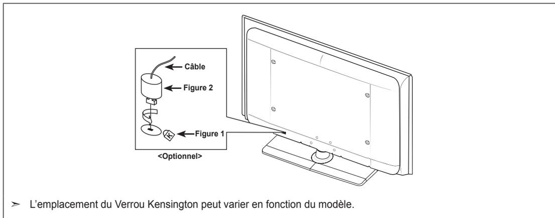
1. Insérez le dispositif de verrouillage dans la fente Kensington de la télévision LCD (Figure 1) et tournez-le dans le sens de verrouillage (Figure 2).
