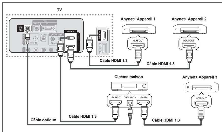
1. Raccorder la prise [HDMI1], [HDMI2] ou [HDMI3] du téléviseur à la prise de sortie HDMI OUT de l'appareil Anynet+ correspondant à l'aide du câble HDMI.
