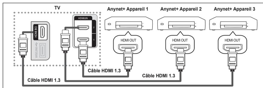
Raccorder la prise [HDMI 1], [HDMI 2] ou [HDMI 3] du téléviseur à la prise de sortie HDMI OUT de l'appareil Anynet+ correspondant à l'aide du câble HDMI.
