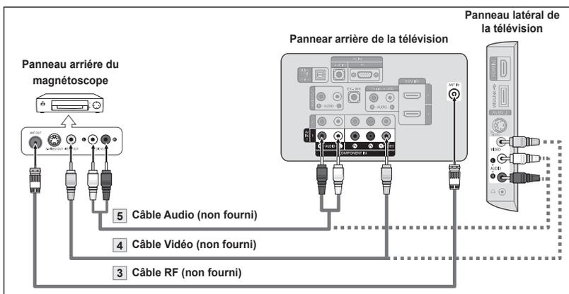
Suivez les instructions de "Visualisation d'une cassette à l'aide d'un magnétoscope ou d'un caméscope" pour visualiser une cassette à l'aide de votre magnétoscope.
