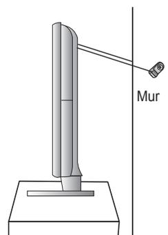
4. S'assurer que tous les points d'ancrage sont solides. Il faut les vérifier périodiquement afin de détecter tout signe de fatigue. En cas de doute au sujet des points d'ancrage, communiquer avec un installateur professionnel.
