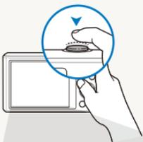
Enfoncez le **[Déclencheur]** à mi-course pour régler la mise au point. L'appareil photo règle automatiquement la mise au point et l'exposition.
