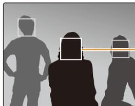
Le visage le plus proche de l'appareil photo ou du centre de la prise apparaît dans un cadre de mise au point tandis que les autres sont encadrés en gris.
