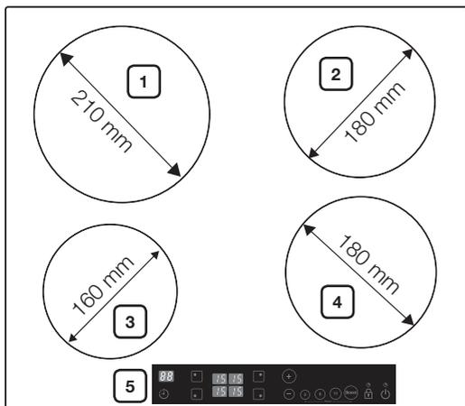
1. Zone de cuisson à induction de 2200 W avec augmentation de la puissance de 3200 W
