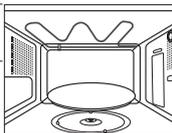
Pour faciliter le nettoyage de la partie supérieure de la cavité du four, inclinez la résistance d'environ 45°.
