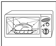
1. Les micro-ondes générées par le magnétron sont distribuées de façon homogène à l'aide du plateau tournant. De cette manière, les aliments cuisent uniformément.
