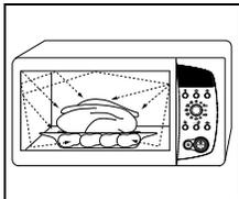
1. Les micro-ondes générées par le magnétron sont réparties uniformément lorsque les aliments tournent sur le plateau. Ils sont cuits de tous les côtés.
