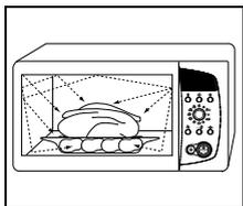
1. Les micro-ondes générées par le magnétron sont réparties uniformément lorsque les aliments tournent sur le plateau. Ils sont cuits de tous les côtés.
