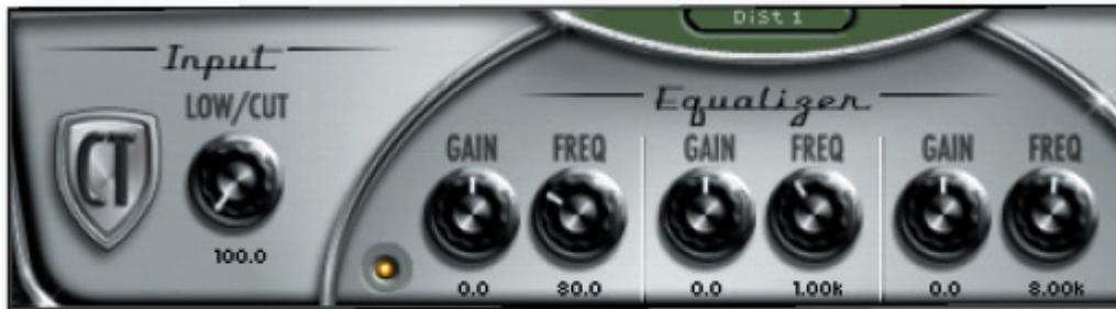
La section d'entrée du Chrome Tone Amp dispose d'un filtre passe-haut (ou coupe-bas) permettant de supprimer les composantes continues et les basses fréquences du trajet du signal. En général, les pistes de guitare sont empreintes de ronflement à 50 Hz (60 Hz aux USA et au Canada) — ce ronflement est automatiquement éliminé par le filtre passe-haut.
