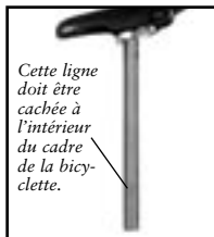
Figure 3.13 - Repère d'insertion minimum sur la tige de selle
