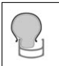
Figure 3.84 - Insérez la chambre à air dans la jante
