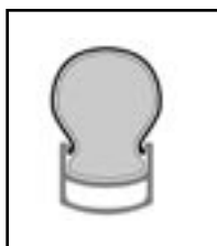
Figure 3.86 - Chambre à air maintenue par la jante et le pneu
