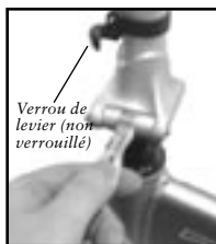
Figure 3.110 - Ouverture du dispositif à déblocage rapide inférieur
