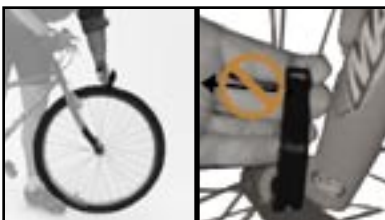
Figure 1.15 - Vérifiez que toutes les pièces sont serrées
