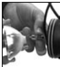
Figure 3.114 - Remplacement de l'ampoule de la lampe
