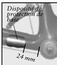
Figure 3.105 - Dispositif de protection de base
