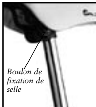
Figure 3.11 - Boulon de fixation de selle avec utilisation d'une clé de 13 ou 14 mm
