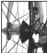
Figure 3.80 - Déplacez la roue et le dérailleur vers la gauche
