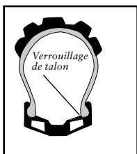
Figure 3.91 - Engagemement de talon avec le crochet de jante
