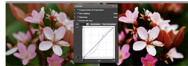
Une courbe dite en S, du fait de sa forme, rend l'image contrastée et « claquante »
