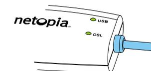
Abb. 11 Anzeigen bei USB-Anschluss
