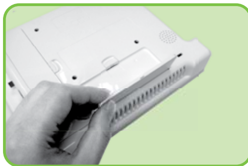
2. Sortez le pied et poussez le pour le bloquer en position horizontale
