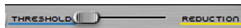
Le curseur de contrôle Threshold/Reduction permet de ne voir que les curseurs Threshold, que les curseurs Reduction, ou un pourcentage des deux simultanément
