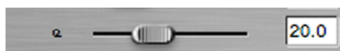
Les valeurs de Q (largeur de bande) peuvent être ajustées avec un curseur ou en entrant une valeur numérique
