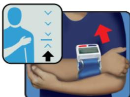
4. Lorsque l'appareil est correctement positionné, le symbole d'un cœur s'affiche sur l'écran et un bip retentit. La mesure commence alors automatiquement.
