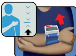
4. Cuando alcance la posición correcta, en la pantalla aparecerá el símbolo de un corazón y escuchará una señal acústica. Entonces la medición empezará automáticamente.
