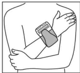
Om deze reden, heeft de Braun SensorControl een uniek positioneringssysteem: de sensor-pijltjes op het display begeleiden uw arm actief naar de juiste meetpositie ter hoogte van het hart.
