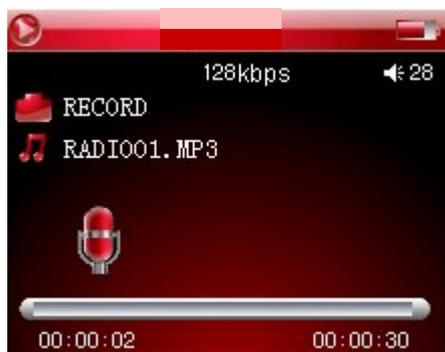
Appuyez sur le bouton « A – B » pendant l'émission pour commencer l'enregistrement. Appuyez sur le bouton « / » pour placer l'enregistrement en pause. Maintenez le bouton Menu enfoncé pour terminer l'enregistrement. L'enregistrement est automatiquement sauvegardé.
