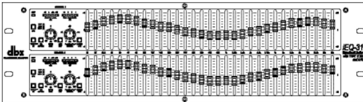
**Bouton de gain d'entrée :** Ce bouton détermine le niveau d'entrée du signal dans l'égaliseur. Il offre une plage de gain de -12 dB/+12 dB. Son action est visible sur l'afficheur de niveau de sortie.
