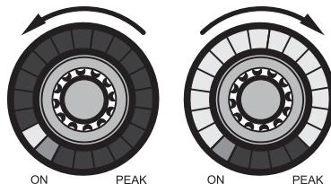
Abbildung 19: LED - Kranz beim Aus- / Einschalten einer Funktion
