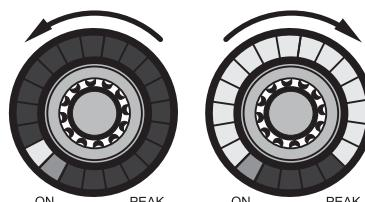
Figure 16: Anneau de LED lors de l'activation/désactivation d'une fonction
