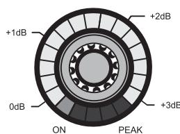
Abbildung 18: Teilung des LED - Kranzes der NOM-ATT. Funktion
