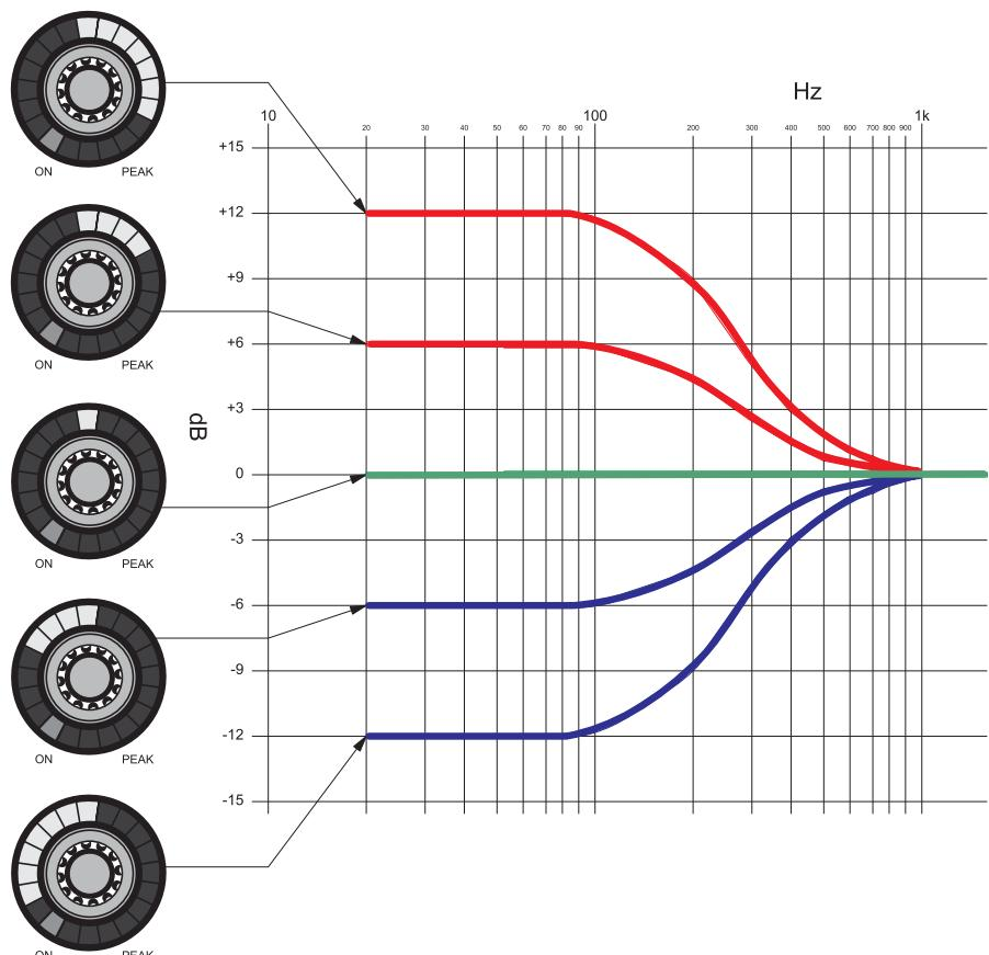
Figure 13: Possibilité de réglage de la fonction BASS
