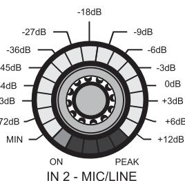
Abbildung 10: Teilung des LED - Kranzes der LEVEL Funktion
