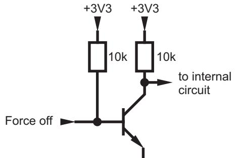
Abbildung 5: Diagramm FORCE OFF
