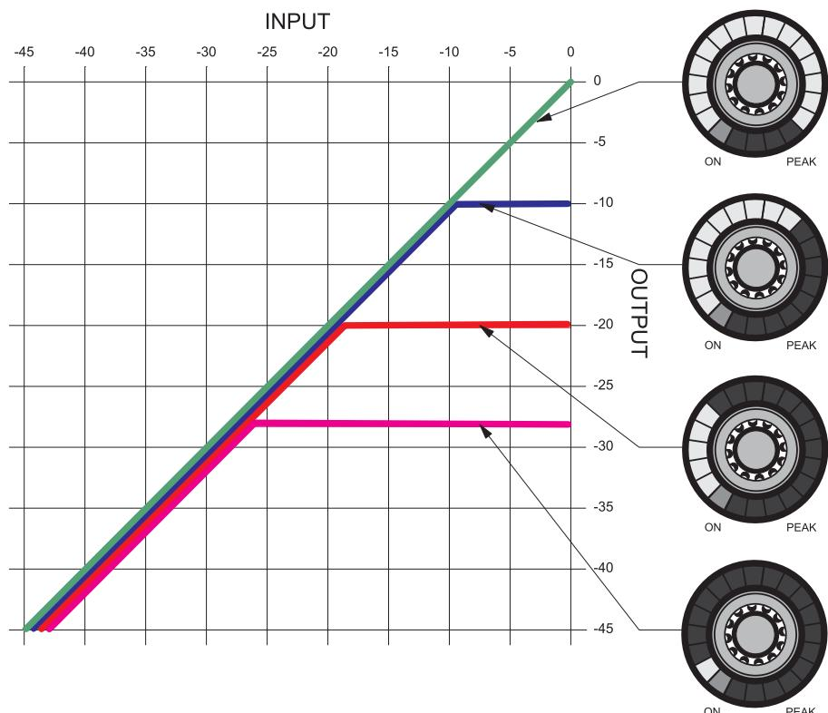
Figura 15: Posibilidad de regulación de la función LIMITER
