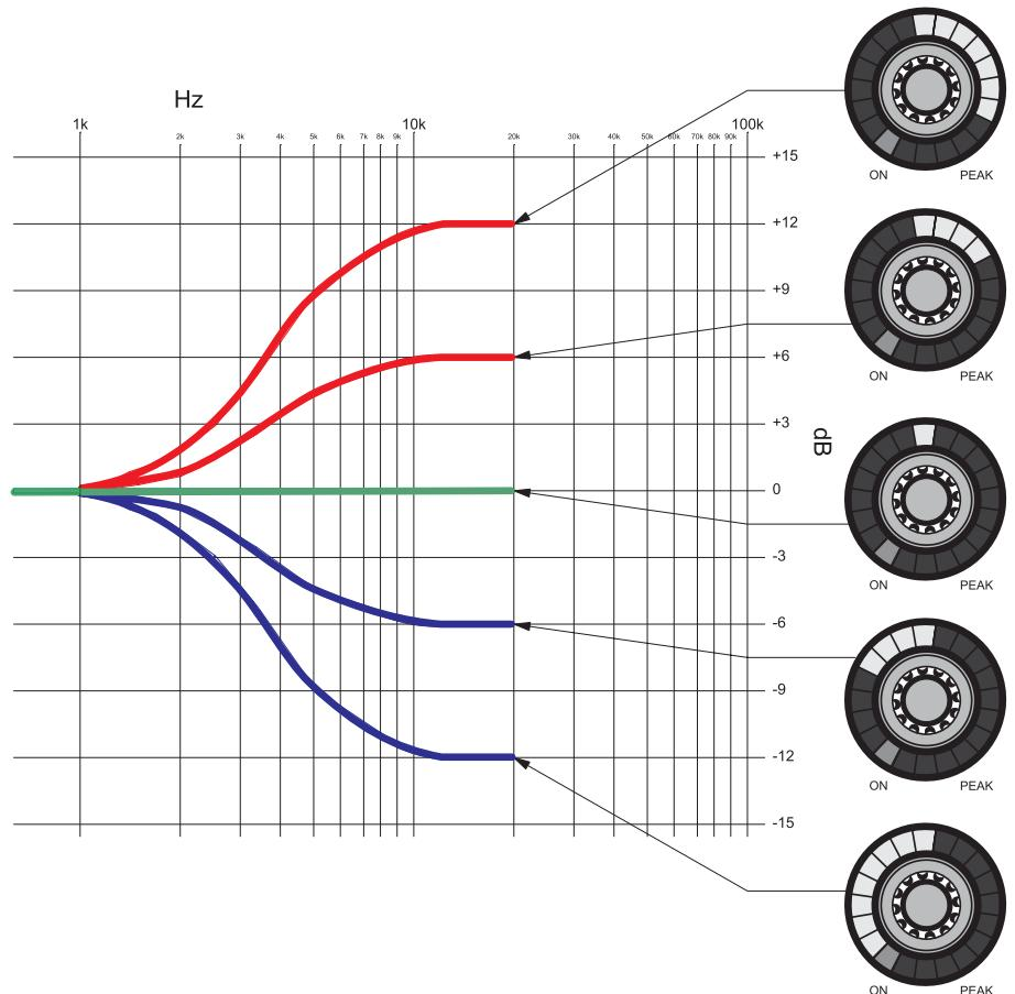
Figura 12: Posibilidad de regulación de la función TREBLE
