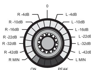
Abbildung 20: Teilung des LED - Kranzes der BALANCE Funktion
