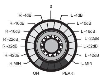
Figura 20: División de la corona de LED de la función BALANCE
