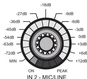
Figura 10: División de la corona de LED de la función LEVEL
