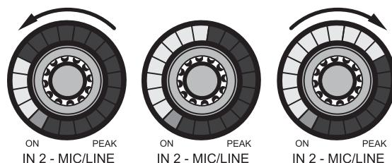
Figura 11: Posibilidad de regulación de la función LEVEL
