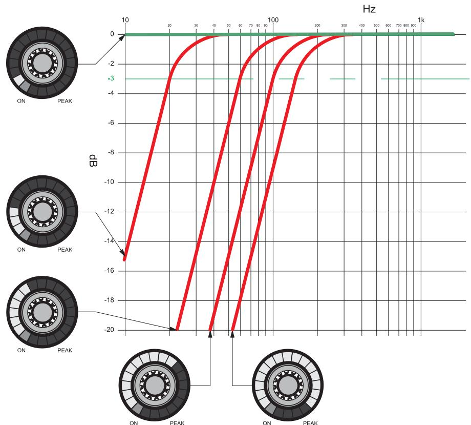
Figura 14: Posibilidad de regulación función LOW CUT
