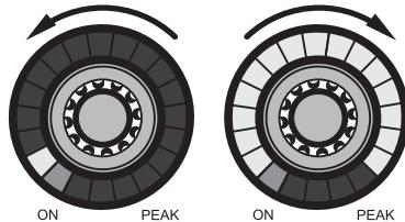
Figure 17: Anneau de LED lors de l'activation/désactivation d'une fonction
