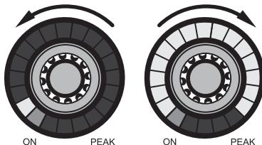
Abbildung 17: LED - Kranz beim Aus- / Einschalten einer Funktion
