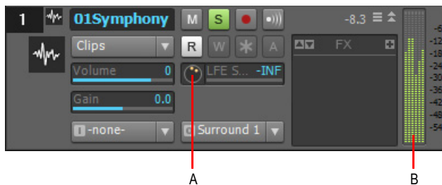
A. Panoramique surround au format Micro dans la vue Pistes B. Vumètre de sortie à six voies
