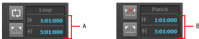
A. La boucle démarre et s'arrête ici B. La zone de punch-in/out démarre et s'arrête ici
