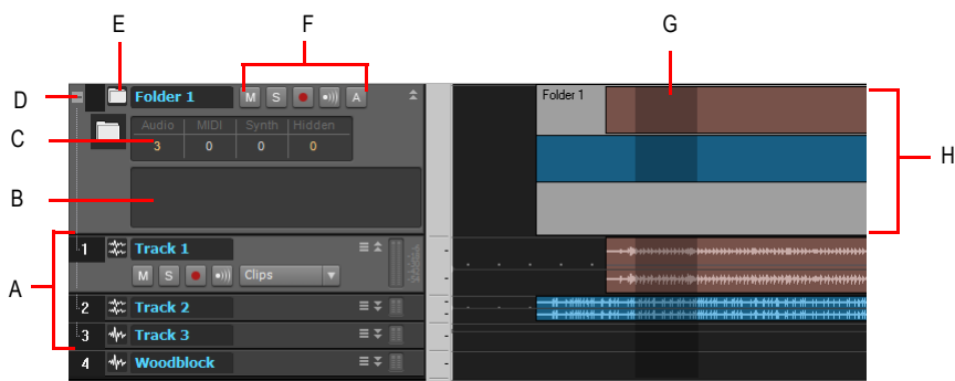
A. Les pistes du dossier de pistes sont reliées B. Champ Description C. Informations sur le dossier de pistes D. Ouvrir/fermer le dossier E. Dossier de pistes — cliquez ici pour sélectionner toute les données d'un dossier de pistes F. Boutons Archiver, Mute, Solo, Armer et Écho d'entrée G. Zone sélectionnée d'un clip composite H. Clip composite
