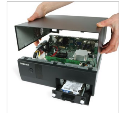
ACCÈS SANS OUTIL AUX COMPOSANTS - Retrait rapide du disque dur de la face avant
