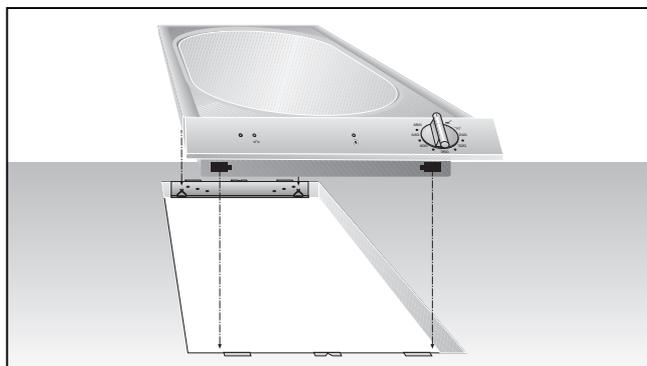
– **Réalisez la découpe** dans votre plan de travail pour un plusieurs appareils Vario. Pour ce faire, basez-vous sur le schéma de pose et le tableau des cotes. Ce dernier indique l'encombrement de la barrette de jonction entre les appareils.
