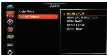
Vous pouvez sélectionner un format de sortie audio numérique d'un téléviseur HDMI ou d'un récepteur audio numérique connecté à cette unité. Les données brutes sont un débit audio d'origine et le LPCM est un débit audio décodé.
