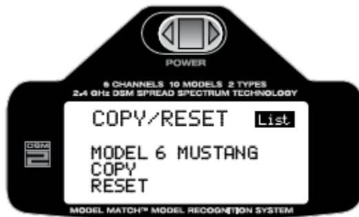
Lorsque la mémoire de modèle désirée a été sélectionnée, appuyez sur le roller pour mettre YES en surbrillance, à côté de SURE, et puis appuyez dessus pour copier le modèle sur la mémoire sélectionnée.
