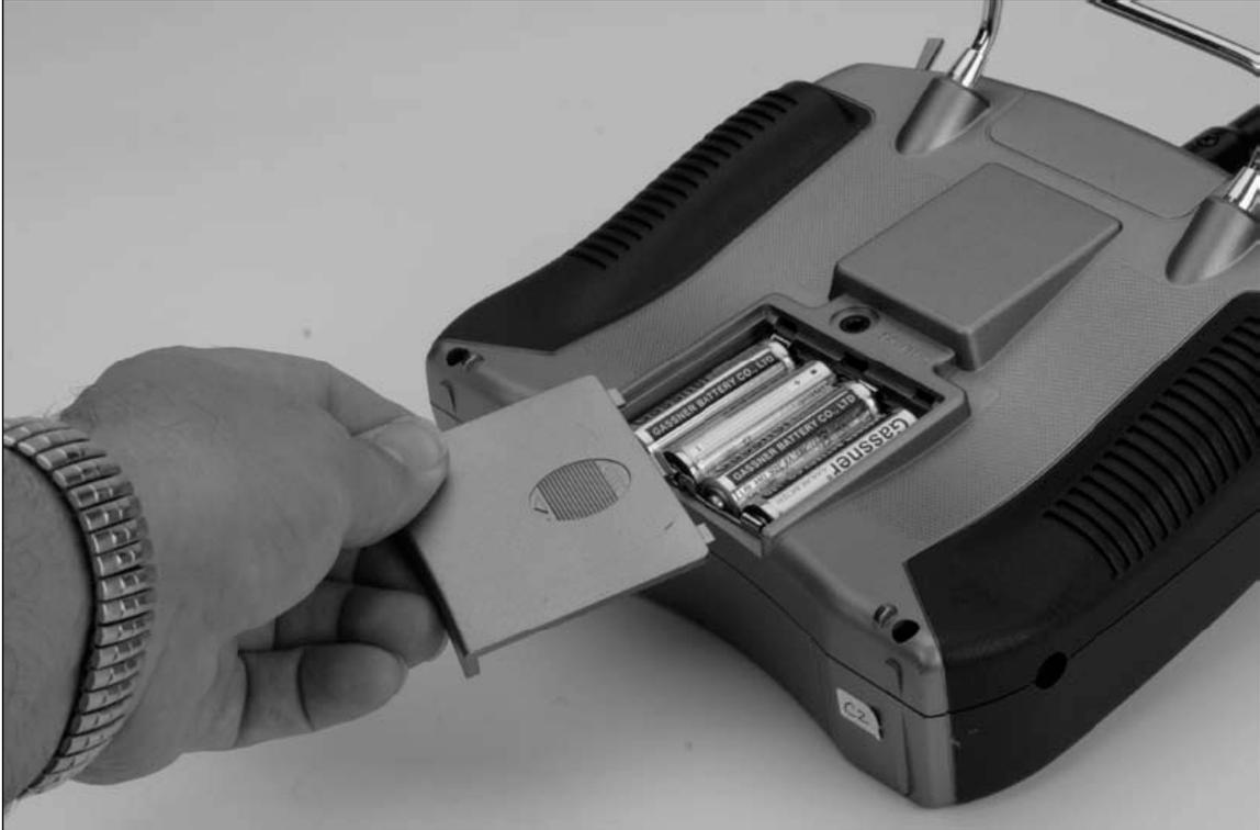
Retirez le couvercle du compartiment-piles et introduisez les 4 piles AA. Veillez à ce que la polarité de chaque pile correspond au diagramme illustré dans le compartiment. Remettez le couvercle en place.
