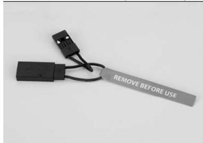
6. Après avoir programmé votre modèle, il est important d'effectuer à nouveau le processus de liaison pour confirmer la programmation effective du faible régime des gaz et des positions de contrôle des gouvernes au point mort.
