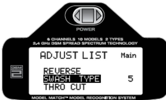
Tournez le roller pour sélectionner le Mix des plateaux oscillants : 1 servo 90 degrés ou bien CCPM 120 degrés.
