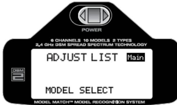
Le cas échéant, il est possible d'accéder à l'écran Setup à partir de l'écran principal, en appuyant sur le roller pour accéder à ADJUST LIST, puis en faisant défiler ADJUST LIST, à l'aide du roller afin de mettre SETUP LIST en surbrillance, puis en appuyant sur le roller.
