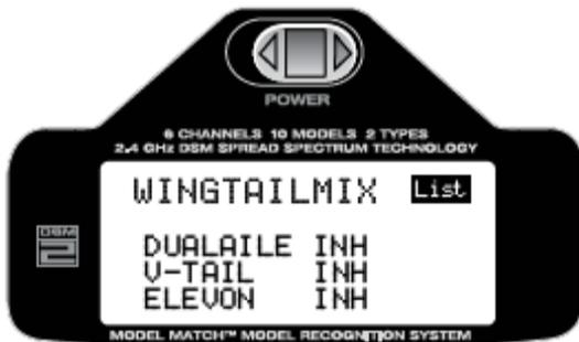
**Nota :** lorsque le type Flaperon ou Delta Wing est sélectionné, le réglage du déplacement permet de régler la poussée individuelle du servo, tandis que le déplacement combiné des ailerons est réglé avec le double débattement des ailerons (Aileron dual rate). Il est également possible de définir le mode Aileron différentiel. Chaque servo dispose d'interrupteurs d'inversion (Reverse). Pour régler le mode neutre (Neutral) de chaque servo, utilisez la fonction Sub Trim.
