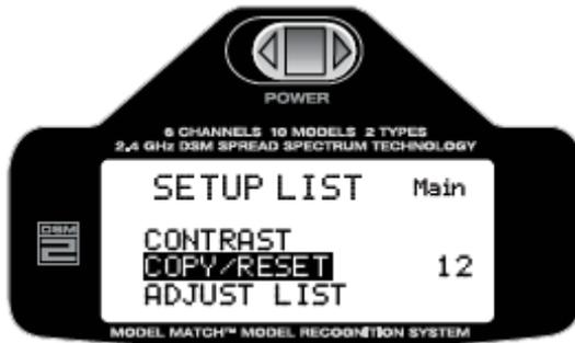
Le cas échéant, il est possible d'accéder à Setup List à partir de l'écran principal, en appuyant sur le roller pour accéder à ADJUST LIST, puis en faisant défiler ADJUST LIST, en tournant le roller afin de mettre SETUP LIST en surbrillance, puis en appuyant sur le roller.
