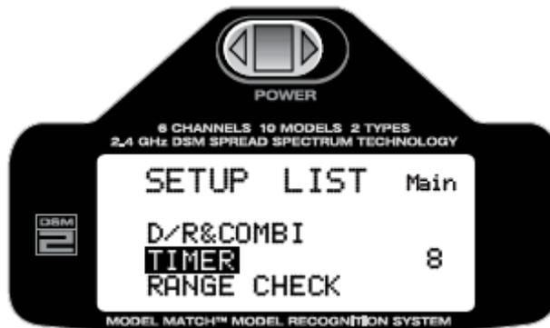
Le cas échéant, il est possible d'accéder à Setup List à partir de l'écran principal, en appuyant sur le roller pour accéder à ADJUST LIST, puis en faisant défiler ADJUST LIST, en tournant le roller afin de mettre SETUP LIST en surbrillance, puis appuyez dessus.
