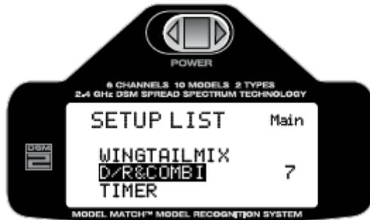
Tournez le roller pour mettre INH en surbrillance, puis appuyez dessus. Tournez maintenant le roller pour sélectionner AILE, ELEV, RUDD ou GEAR.
