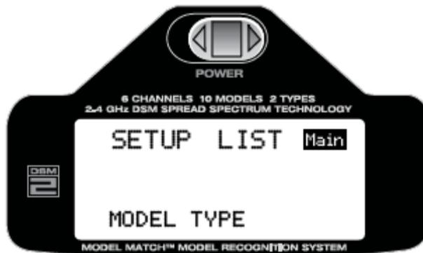
Le cas échéant, il est possible d'accéder à Setup List à partir de l'écran principal, en appuyant sur le roller pour accéder à ADJUST LIST, puis en faisant défiler ADJUST LIST en tournant le roller afin de mettre SETUP LIST en surbrillance ; puis appuyez dessus et SETUP LIST s'affichera.
