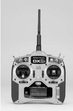
4. Appuyez sur l'interrupteur Ecolage, situé en haut de l'émetteur, et maintenez-le enfoncé et, simultanément, activez l'interrupteur d'alimentation. Le système devrait se connecter en quelques secondes ; les DEL prévus sur les récepteurs devraient être allumés sans clignoter, pour indiquer que le système est bien connecté.
