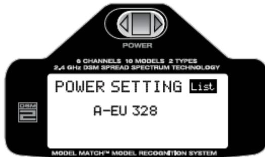
Tournez le roller pour mettre Power setting en surbrillance, puis appuyez dessus. Tournez maintenant le roller pour sélectionner A-EU 328 dans les cas des pays de l'UE, situés en dehors des USA, et sélectionnez B-US 247 si le système est destiné à être utilisé aux Etats-Unis et dans les pays en dehors de l'UE.
