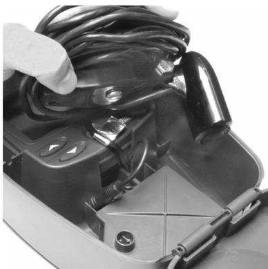
**Placez la sonde au-dessus du compartiment des piles.**
