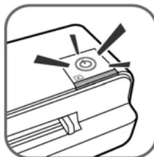
1. La face à numériser doit être orientée vers le haut et dans le bon sens (référez-vous à **Orientation du document et de l'image numérisée** à la page 9), placez le coin du document sur le scanner et ajustez le guide papier afin que le document soit aligné sur le côté gauche de la fente d'alimentation papier.
