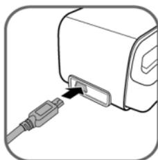
1. Connectez la petite fiche du câble USB (fourni avec le scanner) dans le **port** mini USB du scanner.
