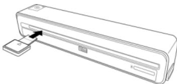
2. Assurez-vous que le scanner est éteint et déconnecté de l'ordinateur et insérez le tampon de nettoyage du capteur par la fente de sortie de papier.
