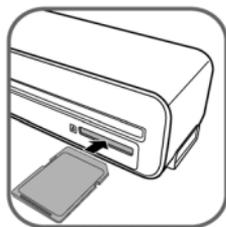
3. Insérez une carte mémoire non verrouillée (accessible en écriture) dans l'emplacement pour carte, ou une clé USB dans le **port USB** du scanner.
