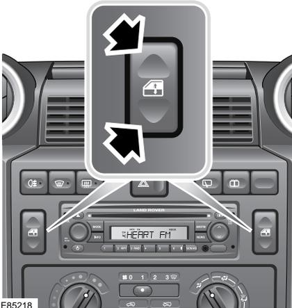
Contact établi ou moteur en marche, appuyez de façon prolongée sur la partie basse du commutateur pour abaisser la vitre. Appuyez de façon prolongée sur la partie haute du commutateur pour relever la vitre. Pour arrêter le mouvement de la vitre, relâchez le commutateur à tout moment.
