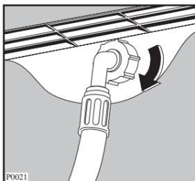
Si le branchement se fait sur des tuyauteries neuves ou qui n'ont pas servi depuis longtemps, il est préférable de faire couler une certaine quantité d'eau avant de mettre en place le tuyau de remplissage. De cette façon, on évitera que du sable ou de la rouille bouche le filtre placé à l'intérieur de l'appareil.
