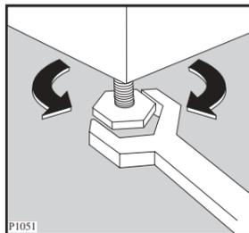
Une mise à niveau correcte évite des vibrations, du bruit ou des déplacements de l'appareil durant son fonctionnement.
