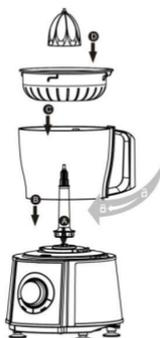
Ne pas remplir le bol au-delà du repère MAX. Verrou de sécurité intégré: le presse-agrumes ne fonctionne que si la passoire est correctement fixée sur le bloc moteur et si le cône est correctement fixé à la passoire. Toutes les pièces doivent être correctement placées, le cône commençant à tourner sitôt que vous tournez le bouton sur la vitesse minimale.
