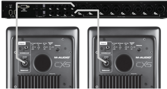
Interface audio (Jack TRS symétrique vers Jack TRS symétrique)
