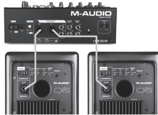
Mélangeur (XLR symétrique vers Jack TRS symétrique)
