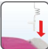
Insérer le guide-fil dans l'ouverture prévue à cet effet
