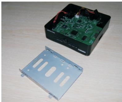
5. Connectez les cordons d'alimentation et SATA entre le disque dur et le boîtier, puis réintégrez le berceau avec le disque dans le boîtier.
