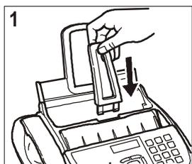
1. Insérez le support des originaux dans la fente correspondante, et poussez-le jusqu'à ce qu'il s'enclenche en position.
