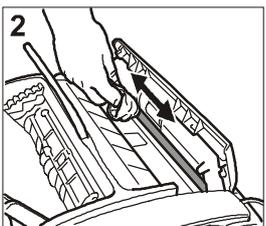
2. Nettoyez le miroir du lecteur optique avec un **chiffon imbibé** d'un produit de nettoyage pour les vitres, puis essuyez-le soigneusement.
