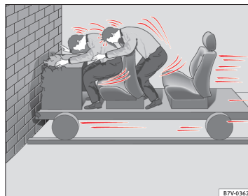
Fig. 7 Le véhicule heurte le mur : les occupants n'ont pas bouclé leur ceinture
