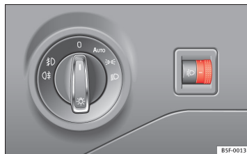
Fig. 62 Côté volant : dispositif de réglage du site des projecteurs.
