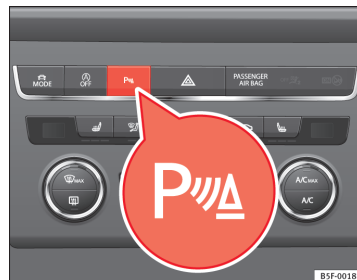
Fig. 104 Console centrale : touche de l'aide au stationnement
