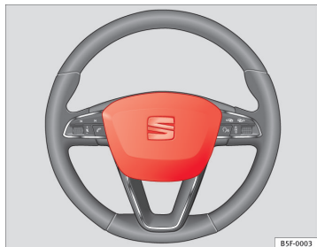
Fig. 17 Airbag du conducteur dans le volant
