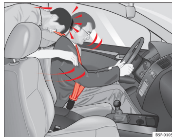
Fig. 9 L'occupant de la banquette arrière non attaché est projeté en avant et vient heurter le conducteur attaché.
