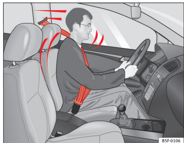
Fig. 10 Conducteur avec ceinture de sécurité correctement bouclée : il est tenu par celle-ci en cas de freinage sec.
