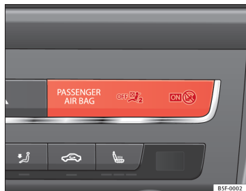
Fig. 16 Témoin sur la planche de bord indiquant la désactivation de l'airbag frontal du passager.
