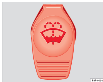
Fig. 112 Compartiment-moteur : Bouchon du réservoir de lave-glace
