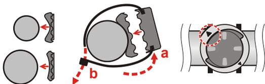
2. Alignez le loquet au dos de l'appareil avec la fente sur le support vélo, puis faites pivoter l'appareil vers la droite pour le verrouiller sur le support vélo.
