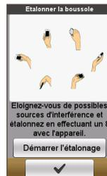
La fonction Etalonnage de la boussole vous permet d'étalonner la boussole intégrée à l'appareil.
