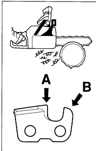
• LA PARTIE COUPANTE de la chaîne consiste en un MAILLON COUPANT qui comporte une dent (A) et UN LIMITEUR (ou cale) DE PROFONDEUR (B). L'espace entre les deux détermine la profondeur de coupe.
