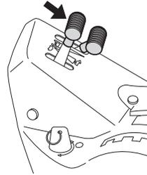
Si le moteur est froid, amener le starter au maximum vers l'arrière.
