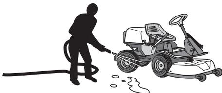
Les dépôts d'huile peuvent être éliminés avec un produit de dégraissage froid. En passer une fine couche.
