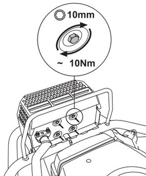
Les variations de températures et les vibrations peuvent desserrer les vis. Pour garantir que les vis sont serrées au couple correct, contrôler les vis lors de chaque mesure d'entretien. Le couple de serrage doit être d'environ 10 Nm. Ne jamais utiliser une machine dont le silencieux est défectueux.
