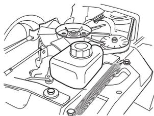
**FR 2216 FA2** Remplir, si nécessaire, avec de l'huile moteur SAE 10W/40 (classe SF-CC).
