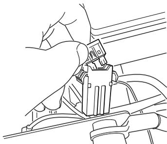
Eviter d'utiliser un autre type de fusible lors du remplacement.
