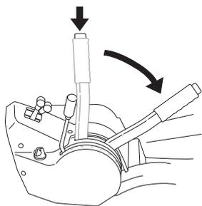
Le levier peut également être utilisé pour régler provisoirement la hauteur de la coupe, par exemple dans le cas d'un léger renflement de la pelouse.
