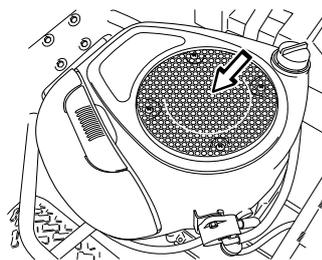
Contrôler le conduit d'air situé sous le capot du moteur. Il doit être propre et ne pas frotter contre la prise d'air de refroidissement.
