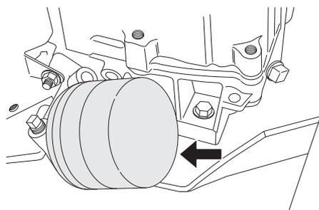
Si nécessaire, utiliser un extracteur de filtre.
