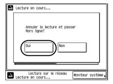
Au bout de quelques secondes, la numérisation est interrompue et l'écran suivant est affiché, indiquant que le scanner est hors ligne.
