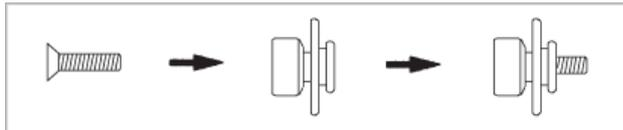
Insérez la vis **B** dans la suspension en plastique.
