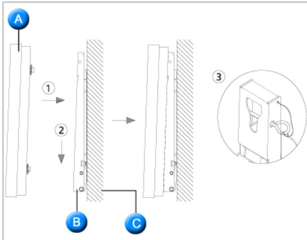
Retirez la goupille de sécurité (3), puis insérez les 4 supports du produit dans les trous correspondants sur la fixation (1). Placez ensuite le produit (2) en veillant à ce qu'il soit solidement attaché à la fixation. Veillez à réinsérer et à serrer la goupille de sécurité (3) pour fixer solidement le produit au support.
