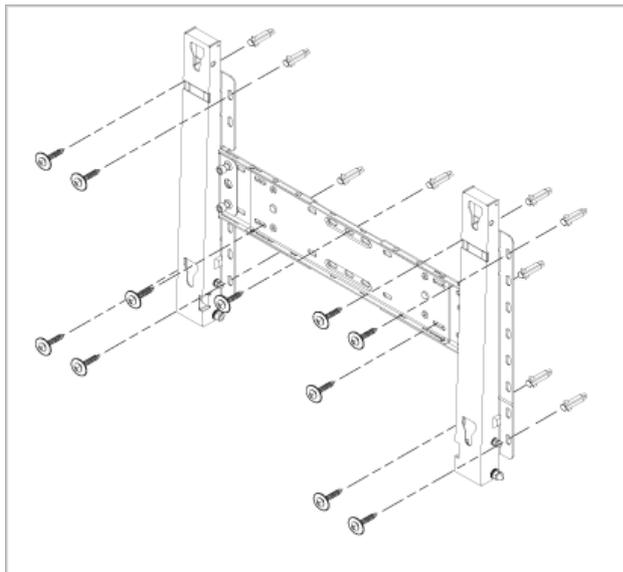
Reportez-vous au schéma d'installation et marquez les trous à percer sur le mur. Utilisez la mèche de 5,0 mm pour percer des trous de plus de 35 mm.
