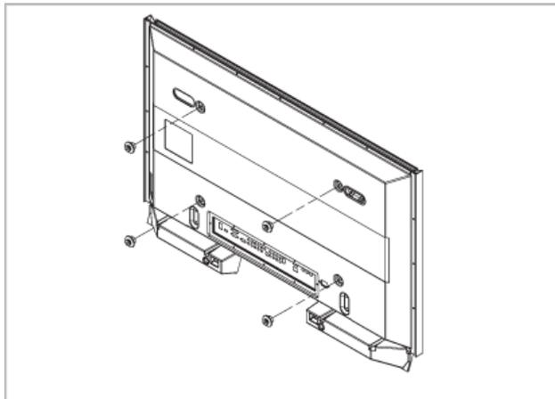
Fixez les 4 vis indiquées à l'étape 2 (suspension en plastique + vis **B**) dans les trous à l'arrière du produit.
