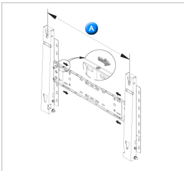
Avant de percer le mur, vérifiez si la distance entre les deux coches d'enclenchement situées au dos du produit est correcte. Si elle est trop longue ou trop courte, desserrez les 4 vis de la fixation murale pour régler la distance.
