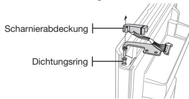
**ACHTUNG** Elektrische Kabel beim Abnehmen der Kunststoffabdeckung nicht beschädigen.
