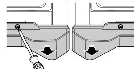
3. Retirez la vis de chaque appareil, placez l'élément de fixation inférieur et revissez.
