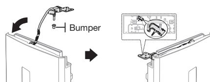
14. Nadat u het scharnier hebt omgeschakeld, sluit u het met de draadbedekking boven op de deur van de koelkast.
