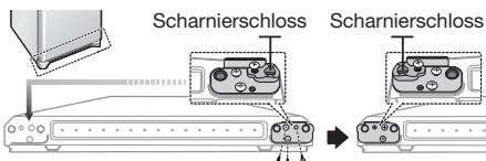
10. Nehmen Sie die Drahtabdeckung an der Oberseite des Geräts ab und klemmen Sie die Drähte an der anderen Seite an.
