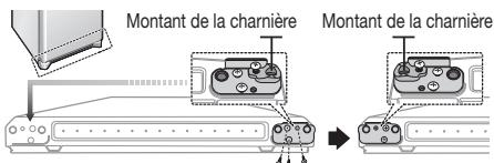
10. Retirez le cache sur le dessus de la porte du réfrigérateur, pour changer les fils de côté.
