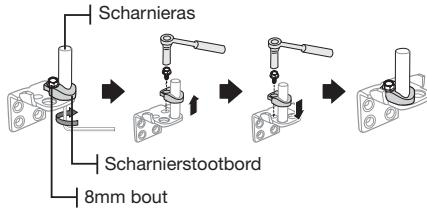
8. Bevestig het scharnier onderaan links van de koelkast, waar in stap 6 bouten zijn verwijderd. Schroef de verwijderde bouten onderaan rechts van de koelkast vast.
