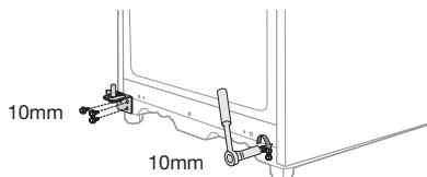
9. Retirez les vis placées sous la porte du réfrigérateur, à gauche et à droite. Retirez les butées de porte du côté droit pour les placer à gauche.
