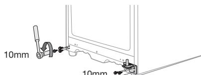
7. Schroef de bout los om het metalen stuk te verwijderen. Verwijder de scharniersas met de inbussleutel en zet de scharniersas en het metalen stuk aan de andere kant.
