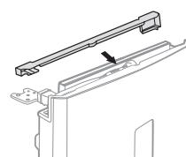
15. Retirez la poignée du côté gauche, pour la placer à droite. (Assurez-vous pour couvrir le côté droit avec les bonnets détachés.)
