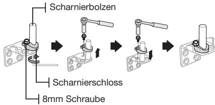
8. Bringen Sie das Scharnier an der unteren linken Seite des Geräts an, an der Stelle, wo vorher die Sechskantschrauben bereits abgenommen wurden (siehe Schritt 6). Die anderen Sechskantschrauben an der rechten unteren Seite des Geräts für eine spätere Verwendung wieder einsetzen.
