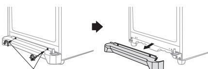
6. Schroef de 3 bouten van het scharnier los en de 3 bouten onderaan links van de voorplint waar het verwijderde scharnier is bevestigd.
