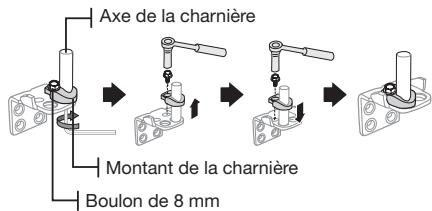
8. Fixez la charnière sur la partie inférieure gauche du réfrigérateur, à l'endroit où se trouvaient les boulons retirés à l'étape 6. Vissez les boulons sur la partie inférieure droite du réfrigérateur pour pouvoir les réutiliser en cas de besoin.
