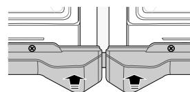
7. Verbinden Sie die untere Befestigung B mit den Schrauben an der Rückseite der Geräte.
