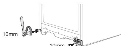
7. Nehmen Sie die Sechskantschraube und das Metallteil ab. Lösen Sie den Scharnierbolzen mit Hilfe des Sechskantschlüssels und bringen Sie den Scharnierbolzen und das Metallteil an der gegenüberliegenden Seite an.
