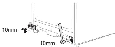
9. Lösen Sie die Schrauben an der unteren linken und rechten Seite der Gerätetür. Setzen Sie den Türdämpfer von rechts nach links um.
