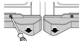
3. Nehmen Sie die Schrauben an beiden Geräten ab, befestigen Sie die untere Halterung und ziehen Sie die Schrauben wieder fest.
