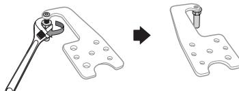
13. Bauen Sie das Scharnier wieder an den Kühlzrank an, dazu befolgen Sie die unter 11 angegebenen Arbeitsschritte in umgekehrter Reihenfolge. Achten Sie darauf, dass Sie die linke Scharnierabdeckung verwenden, welche sich an der Unterseite der unter Schritt 2 abgenommenen Kunststoffabdeckung befindet. Setzen Sie Scharnier, Drähte und Scharnierabdeckung wieder zusammen und wechseln Sie von rechts nach links.
