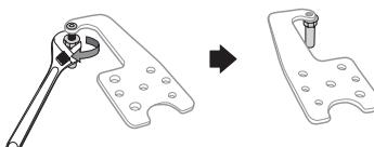
13. Remontez la charnière sur la porte du réfrigérateur en suivant les étapes du point 11 dans l'ordre inverse. Utilisez bien le capot de charnière gauche, que vous trouverez sous le capot de plastique retiré à l'étape 2. Après avoir remonté la charnière, les fils et le capot de charnière, remettez-les en place, mais du côté gauche.
