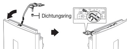
14. Befestigen Sie die Kabelabdeckung nach dem Umsetzen des Scharniers auf der Oberseite der Kühlzranktür.
