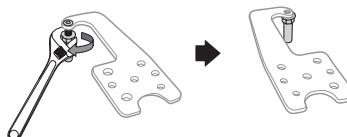
13. Bevestig het scharnier weer op de koelkastdeur door stap 11 in omgekeerde volgorde uit te voeren 11. Let erop dat u de linkerscharnierskap gebruikt die u onder de verwijderde plastic afschermkap uit stap 2 kunt vinden.
