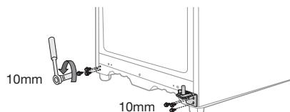
7. Dévissez le boulon pour retirer la pièce métallique. Retirez l'axe du battant à l'aide de la clé hexagonale, et fixez l'axe et la pièce métallique de l'autre côté.
