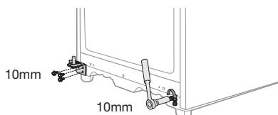
9. Verwijder de schroeven onderaan links en rechts van de koelkastdeur.
