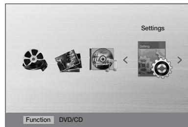
1. Appuyez sur le bouton **POWER (ALIMENTATION)** en mode **NO DISC (PAS DE DISQUE)**, ou Appuyez deux fois sur le bouton **STOP (ARRÊT)** en cours de lecture.
