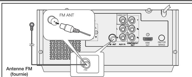
1. Connectez l'antenne FM fournie à la prise d'antenne FM.
