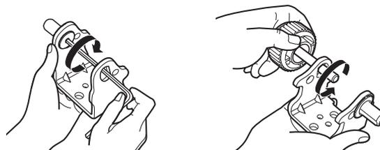
7. Réinstallez les deux charnières inférieures sur le bas du réfrigérateur et fixez-les à l'aide des quatre boulons.
