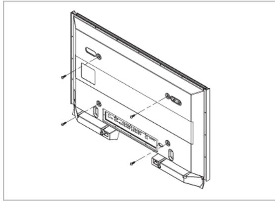
4. Retirez la goupille de sécurité (3) et insérez les 4 crochets du produit dans les orifices correspondant du support mural (1). Placez ensuite le produit (2) de sorte qu'il soit solidement fixé sur le support. Veillez à remettre en place et serrer la goupille de sécurité (3) pour maintenir le produit accroché au support.
