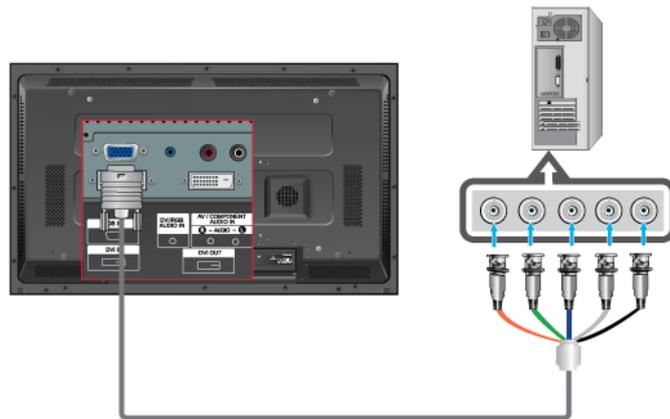
1. Raccordez le port RGB/COMPONENT IN du moniteur au port BNC du PC à l'aide du câble D-SUB vers BNC.
