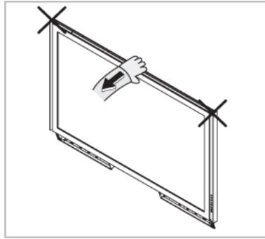
Veillez à utiliser la partie centrale supérieure, pas le côté gauche ou droit du moniteur, pour régler l'angle.
