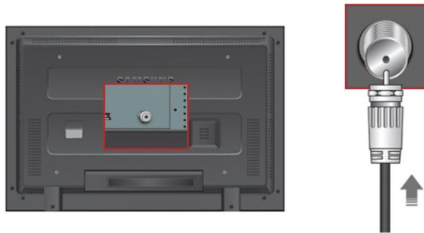
1. Connectez le câble CATV ou le câble d'antenne de télévision au port "ANT IN" à l'arrière de l'écran LCD.
