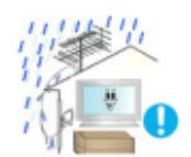
▶ Pliez le câble d'antenne extérieure vers le bas à l'endroit où il rentre, de manière à éviter toute infiltration d'eau de pluie.
