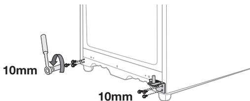
7. Dévissez le boulon pour retirer la pièce métallique. Retirez l'axe du battant à l'aide de la clé hexagonale, et fixez l'axe et la pièce métallique de l'autre côté.
