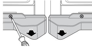
3. Retirez la vis de chaque appareil, placez l'élément de fixation inférieur et revissez.
