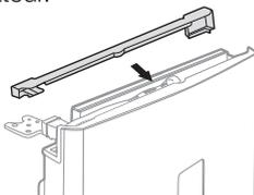
15. Retirez la poignée du côté gauche, pour la placer à droite. (Assurez-vous pour couvrir le côté droit avec les bonnets détachés.)
