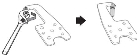
13. Remontez la charnière sur la porte du réfrigérateur en suivant les étapes du point 11 dans l'ordre inverse. Utilisez bien le capot de charnière gauche, que vous trouverez sous le capot de plastique retiré à l'étape 2. Après avoir remonté la charnière, les fils et le capot de charnière, remettez-les en place, mais du côté gauche.
