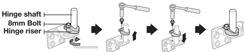
8. Fixez la charnière sur la partie inférieure gauche du réfrigérateur, à l'endroit où se trouvaient les boulons retirés à l'étape 6. Vissez les boulons sur la partie inférieure droite du réfrigérateur pour pouvoir les réutiliser en cas de besoin.
