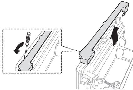
11. Retirez la charnière de la porte du réfrigérateur. Retirez le capot de la charnière droite et tirez les fils pour les sortir du capot.
