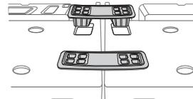
6. Remplacez le couvercle avant sur les deux appareils.
