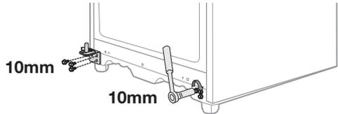
9. Retirez les vis placées sous la porte du réfrigérateur, à gauche et à droite. Retirez les butées de porte du côté droit pour les placer à gauche.
