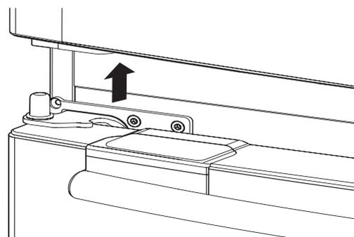
5. Avec un tournevis à tête Philips, retirez les deux vis (10) fixées aux charnières de porte inférieures gauche et droite. Avec une clef Allen (3/16 po), retirez les deux boulons à tête hexagonale (11) fixés aux charnières de porte inférieures gauche et droite. Retirez les charnières de porte inférieures gauche et droite (12).
