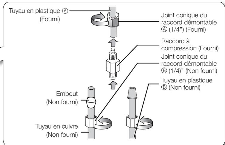
1. Glissez le joint conique du raccord démontable (A) à travers le tuyau en plastique (B) fourni.
