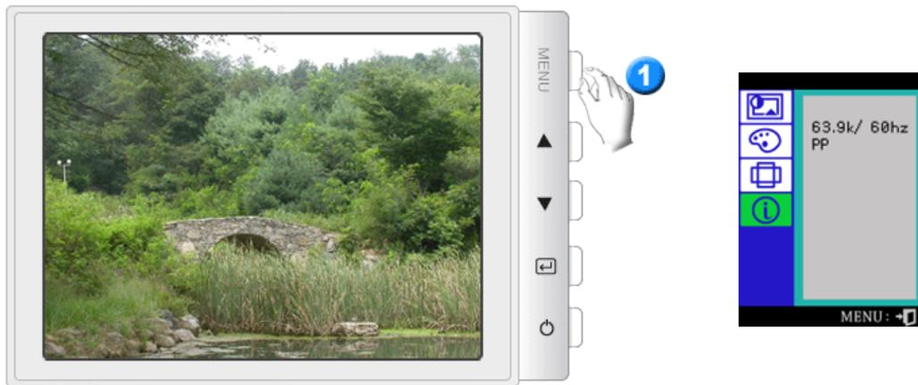
Vous pouvez voir la fréquence (mode de contrôle d'utilisateur) employée par l'utilisateur, la polarité des signaux opérationnels, la fréquence par défaut (mode par défaut) installés lorsque vous achetez le moniteur et le niveau de resolution.
